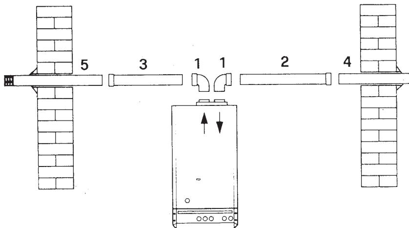
Maximální ztráta odtahu: **80 Pa** ( platí pro všechny kotle s uzavřenou spalovací komorou ).
