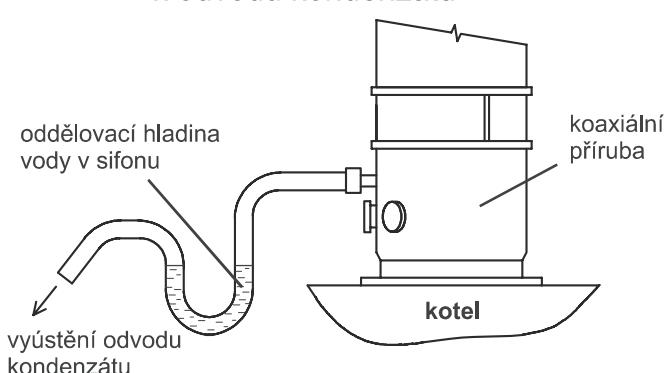
**Koaxiální odtah vertikální - sestava se dvěma koleny 45°, L= max 1 m**
