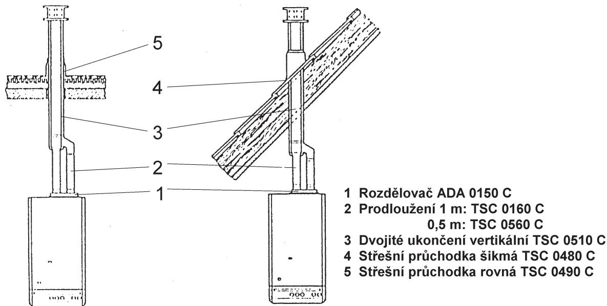
**Dvoutrubkové provedení vertikální pro šikmou střechu - sestava se dvěma koleny**
