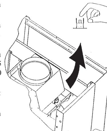
Obr. Odblokování spalinového termostatu
