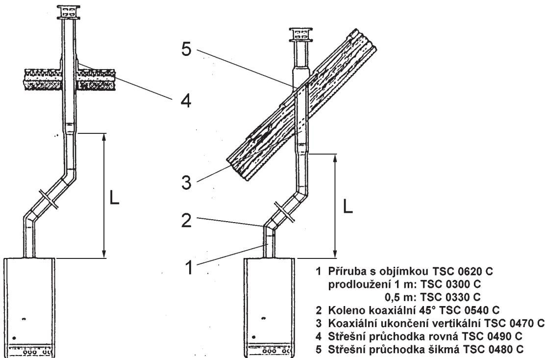
**KOAXIÁLNÍ PROVEDENÍ - jednotlivé díly**
