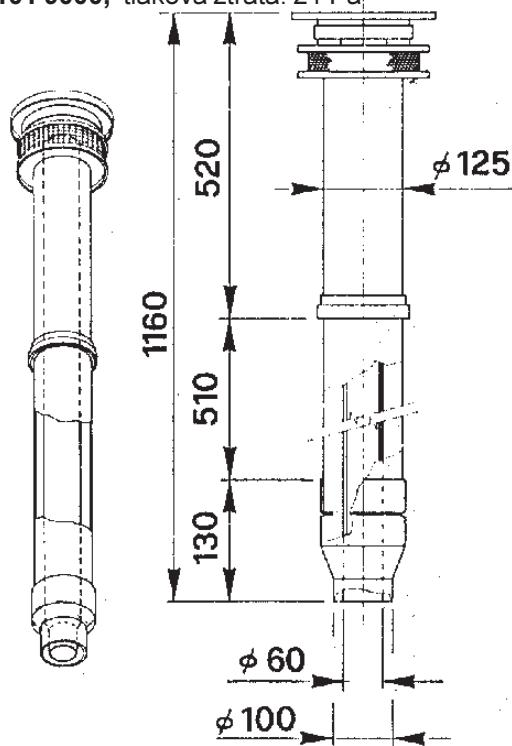
Poznámka: Hlavice musí být umístěna minimálně 400 mm nad všemi okolními konstrukcemi v okruhu do 4 metrů, aby nedocházelo k vření okolního vzduchu kolem hlavice, které by mohlo způsobit nasávání spalin do trubky přívodu vzduchu.
